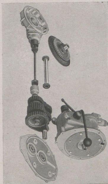
Das nebenstehende Bild zeigt den seit Jahren erfolgreichen Zündapp-Kardan-Antrieb mit torsionsfedernder Kardanwelle. Zusammen mit den an sich schon stoßdämpfenden Duplexketten des Viergang-Getriebes bringt es der Zündapp-Mehrzylinder-Maschine besonders gute Fahreigenschaften. Fahrer, die das erste Mal eine K 500 oder KS 600 probefahren, werden begeistert sein von der bis dahin noch nicht gekannten, weich arbeitenden und ruckfreien Kraftübertragung.
