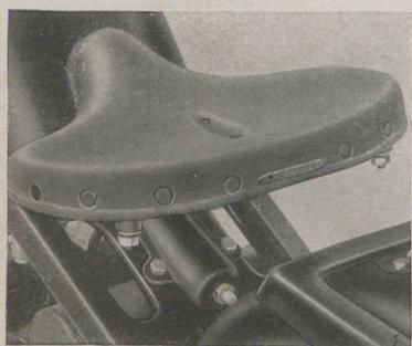
Ein bequemer Sattel in Verbindung mit einem richtig eingestellten Lenker und ebensolchen Fußrasten trägt viel zu einem ermüdungsfreien Fahren über große Strecken bei. Das Bild zeigt den Schwingsattel der DBK 250. Ab DBK 250 sind alle Modelle mit Schwingsätteln ausgerüstet. Sämtliche Modelle haben verstellbare Fußrasten u. Lenker.
